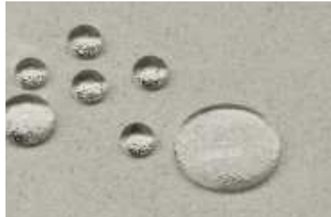
Hydrofobizácia robí stavebný materiál vodoodpudivým.
